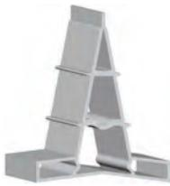
Kunststoffprofil für das problemlose Herstellen von Arbeitsfugen (Sollbruchstellen) bei Bodenplatten. Erspart den aufwändigen Fugenschnitt und Fugenverguss. Hervorragende Verzahnung im Beton. Exakte Maßhaltigkeit, daher auch als Führung von Abziehleisten bestens geeignet.
