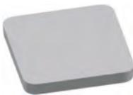
Stabile Montageplatte aus Kunststoff in unterschiedlichen Abmessungen. LAGERPLATTE dient zur Montagehilfe, z. B. beim Aufstellen von Fertigteilen. Vollflächig (nicht punktförmig) belasten. Trotz ihrer hohen Stabilität darf keine Dauerbelastung erfolgen, nach dem Justieren müssen die Bauteile unterfüttert werden.
