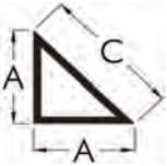
Bauprofile aus schlagzähem Kunststoff. Sie werden auf die Schalung genagelt, um Betonkanten um 45 Grad abzuschrägen. Nagellöcher auf Anfrage.
