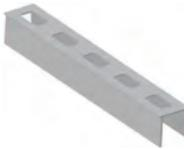
Großflächiger, linienförmiger Abstandshalter für die untere Bewehrung. Insbesondere für den Einsatz auf weichem Untergrund, jedoch muss die Leiste dazu umgedreht werden. Für Sichtbeton und Elementdecken nur bedingt geeignet.
