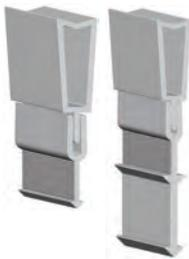
Zweiteilige Kunststoffschiene für die Erzeugung von Sollrissen, die abgedichtet werden müssen. Nach dem Betonieren wird der obere Teil entfernt und die Fuge abgedichtet.
