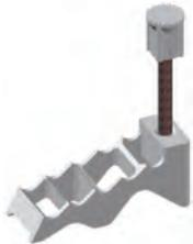
Wandstärken-Abstandshalter für die rationelle Herstellung vorgefertigter Hohlwände. Stabdurchmesser 8 mm. Mit besonders stabilem stufenförmig ausgebildetem Fuß und integrierter Wassersperre. Einbau ohne Einschränkung der Brandklasse (DIN 4102) möglich, da es sich nicht um ein wanddurchführendes Kunststoffteil handelt.
