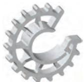
Bewährter Abstandshalter für universelle Verwendung. Klemmende Halterung für mehrere Stabdurchmesser. Verbreiterte Auflage ergibt höhere Kippsicherheit. Offene Konstruktion, die den Betonfluss nicht unterbricht. Außenrippen mit geringer Schalungsberührung.
