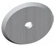
Diese Tropfscheibe verhindert, dass eventuell über die Außenschale eindringende Feuchtigkeit bis zur Innenschale weitergeleitet wird. Tropfscheibe wird etwa bis zur Mitte der Luftschicht auf den Luftschichtanker aufgeschoben.
