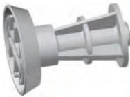
Zum Aufnageln auf Holzschalungen oder Aufkleben auf Stahlschalungen (z. B. mit Heißkleber). Die Halteplatte schützt den Schraubenkanal des Transportdübels und kann wahlweise entfernt werden oder im Beton verbleiben. (Schutzhaut lässt sich mit der spitzen Schraube durchstoßen.)
