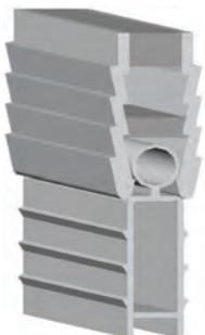
Zweiteiliges Kunststoffprofil für das Herstellen von Fugen im Estrich. Es nimmt geringe Verformungen auf, um Spannungsrisse zu vermeiden. Das Unterteil kann je nach Höhe beliebig erweitert oder entfernt werden.
